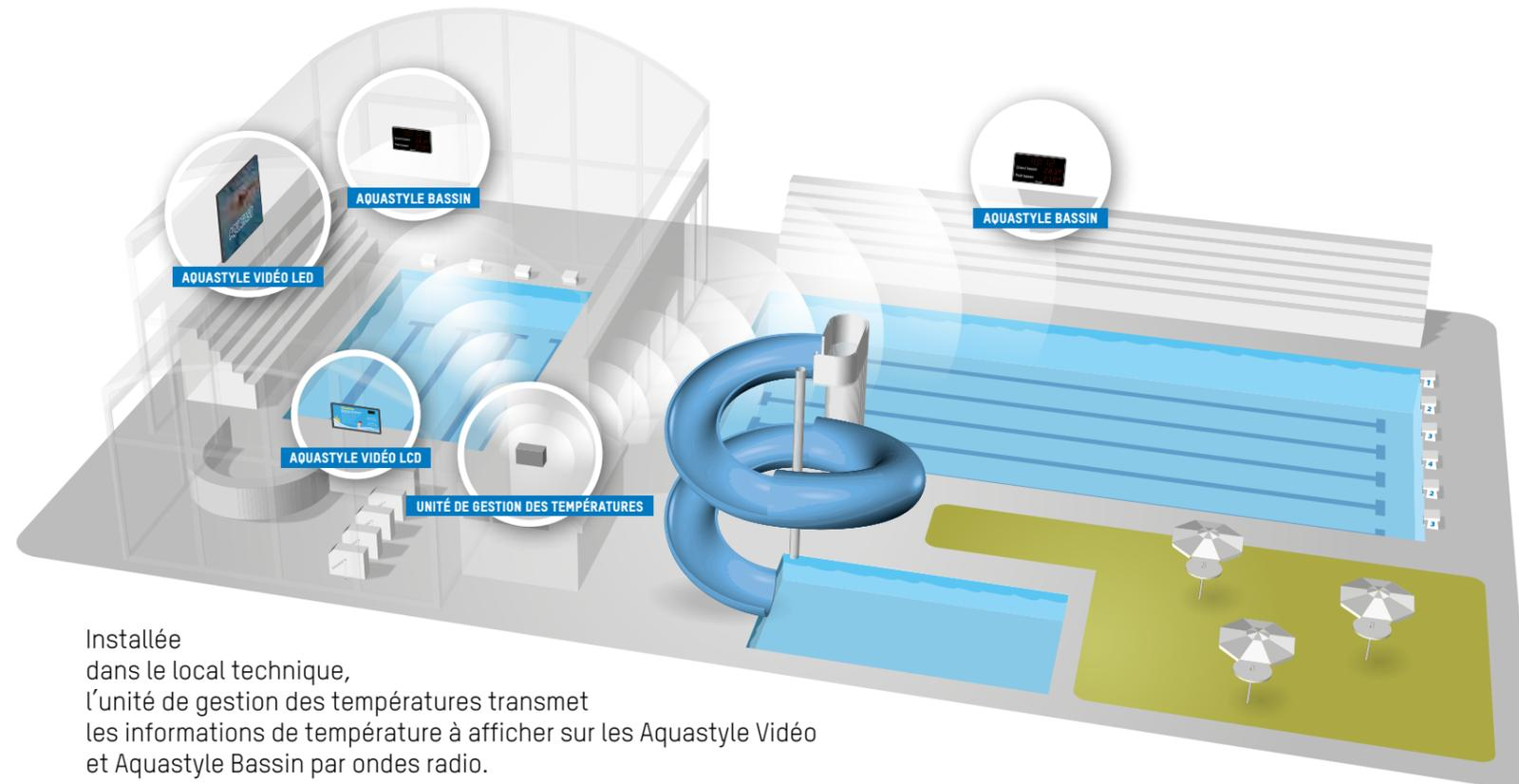
Installée dans le local technique, l'unité de gestion des températures transmet les informations de température à afficher sur les Aquastyle Vidéo et Aquastyle Bassin par ondes radio.
