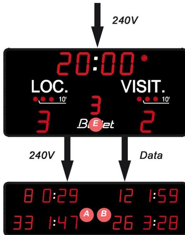
La mayor parte del cableado del BTX6125HK es realizado en la fábrica. Este manual explica sólo el cableado que realizar durante la instalación. Todos los cables a conectar están en la periferia del BT6102E: 1 cable de alimentación con un conector verde (240V) y 1 cable de comunicación con un conector verde (DATA).
