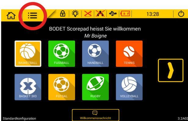
**Schritt 2:** Zugang zum Techniker Menü (Passwort: 4934)
