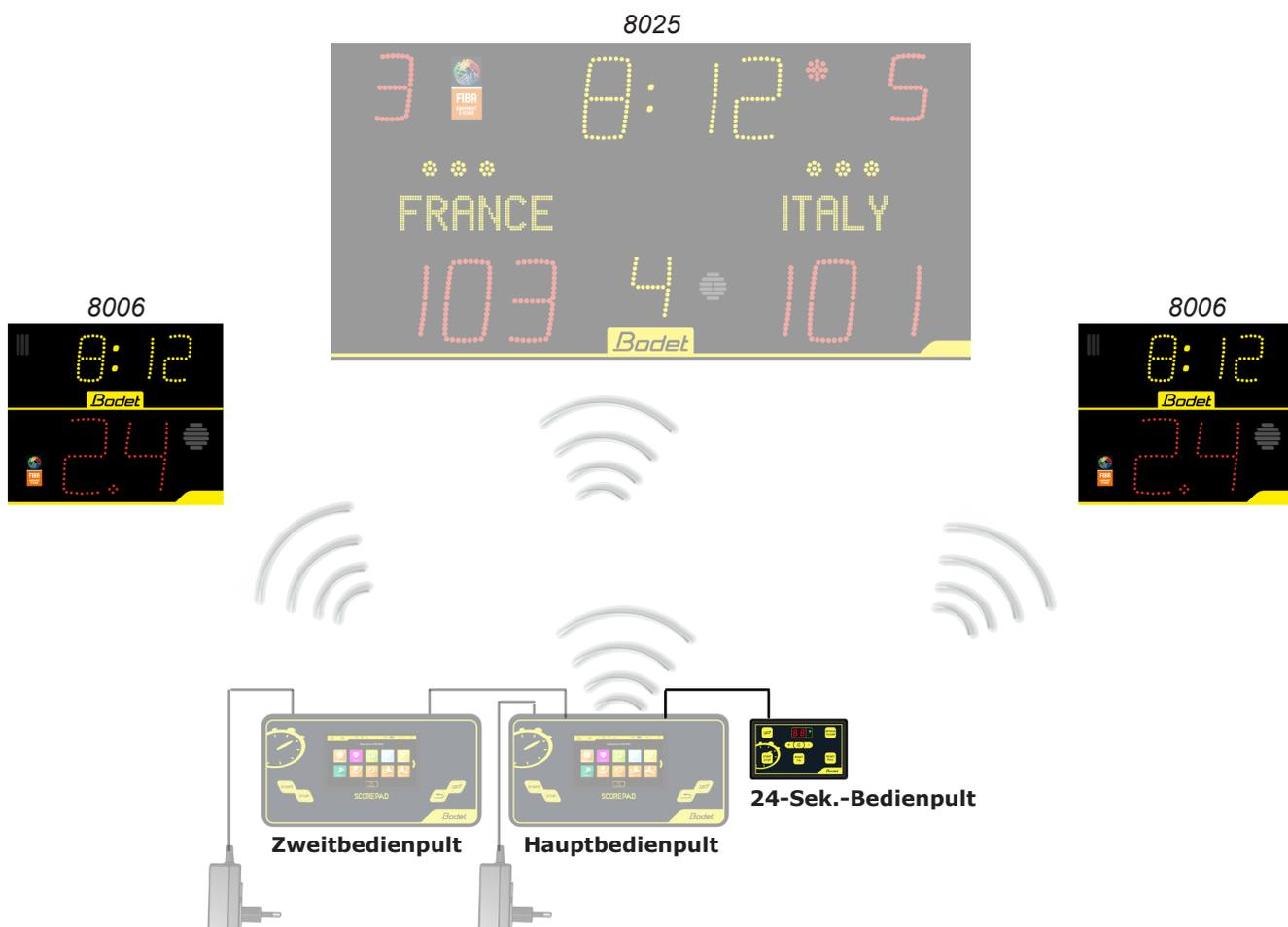
Die Kommunikation mit den Bedienpults für Ballbesitz 8006 geschieht über das Hauptbedienpult.
